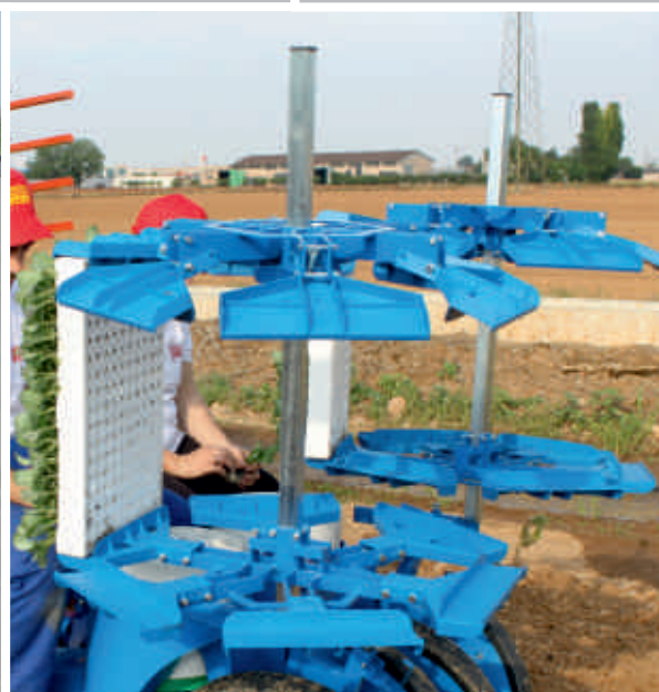
GIRELLO 6 SEDI / TURNING TRAY HOLDER FOR 6 TRAYS PORTE-PLATEAUX TOURNANT POUR 6 PLATEAUX DREHENDES KISTENGESTELL FÜR 6 KISTEN ELEMENTO GIRATORIO 6 ALOJAMIENTOS
