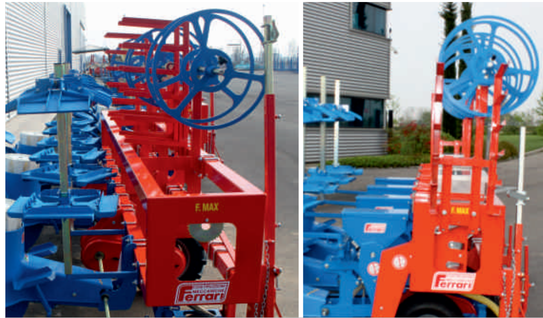
STENDIMANICHETTA CON VOMERE INTERRA MANICHETTA / WATER PIPE STRETCHING TOOL WITH PLOUGH SHARE TO EARTH WATER PIPE UP / SYSTÈME POUR ETENDRE LE TUYAU DE L'EAU AVEC SOC OSCILLANT POUR ENTERRER LE TUYAU DE L'EAU / SCHLAUCHLEGEGERÄT MIT SCHLAUCHUNTERPFLUGSCHAR EXTENSOR MANGUERA Y REJA ENTIERRA MANGUERA
