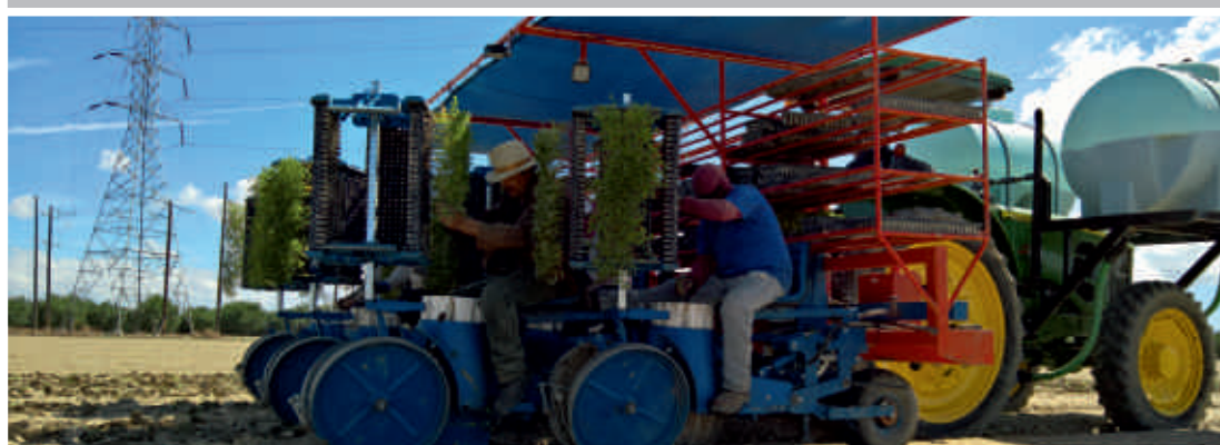
ELEMENTO ALLUNGATO PER INTERFILE MINIMA cm 35 / LONGER ELEMENT FOR ROW WIDTH MIN cm 35 ELEMENT DECALE POUR ENTRE RANGS MIN cm 35 / LANGGESTECKTES ELEMENT REIHENABSTAND MIN cm 35 ELEMENTO ALARGADO PARA INTER-FILA MIN cm 35
