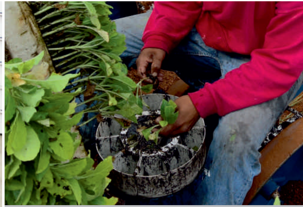
DISTRIBUTORE 10 BICCHIERI / 10-CUP CAROUSEL / DISTRIBUTEUR AVEC 10 GODETS VERTEILER MIT 10 BECHERN / DISTRIBUIDOR CON 10 TAZAS
